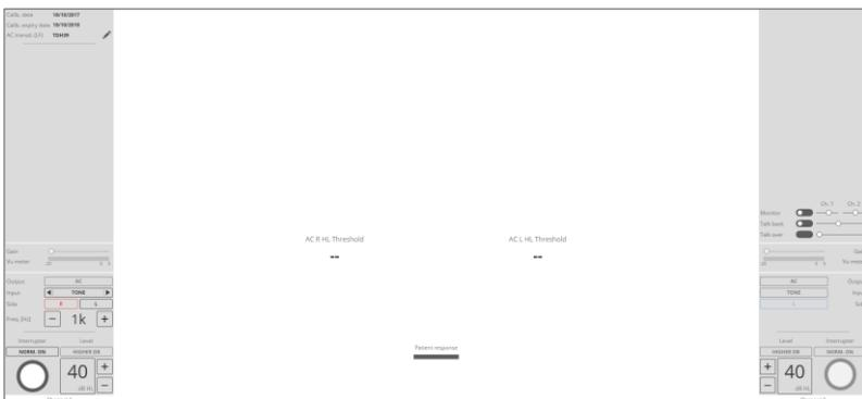
Im linken Bereich kann die dem Kanal 1 zugewiesene Stimulusseite, die dem vom Probanden als schwerhörig angegebenen Ohr entspricht, ausgewählt werden. Die der für Kanal 1 gewählte gegenüberliegende Seite wird automatisch auf den Kanal 2 eingestellt.
